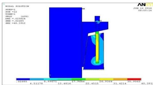
Fig. 11 von Mises stress in bolt
