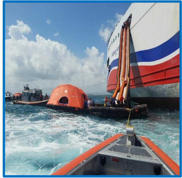
Fig. (2) Close look to the deficient MES
